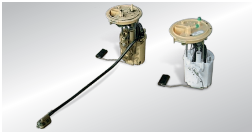
Рис. 2: слева: первоначально встроенный модуль подачи топлива с внешним эжекторным насосом справа: модуль подачи топлива 7.02550.32.0
